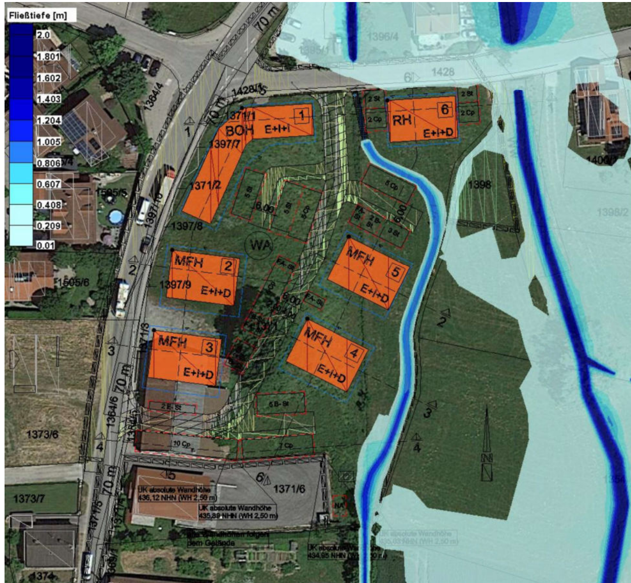
Abbildung 5.2: Überschwemmungssituation im Planungsbereich, Lastfall HQ_{\text{extrem}}
