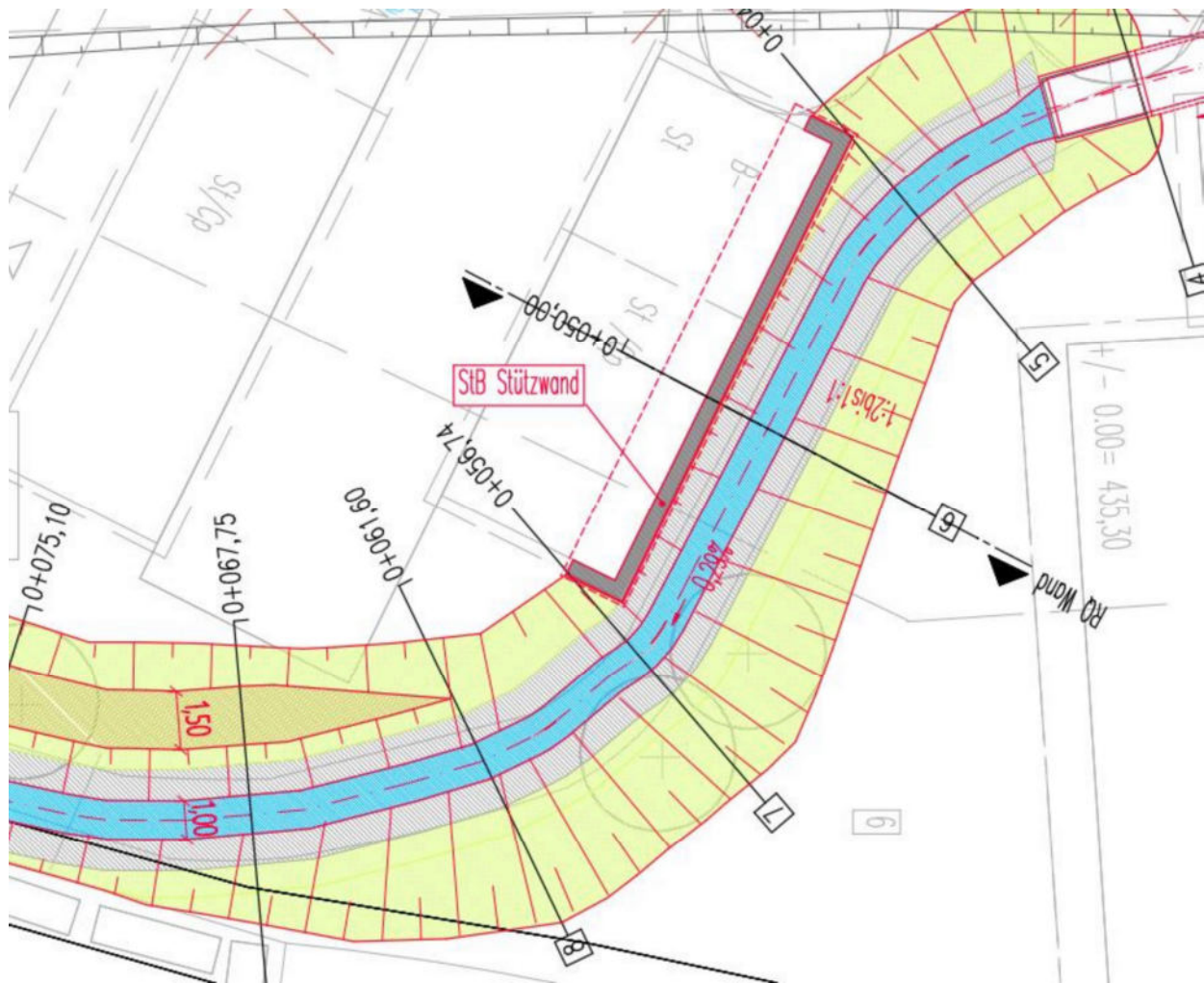
Abbildung 4.6: Auszug aus Lageplan – Gewässerverlauf nördlicher Gewässerabschnitt
