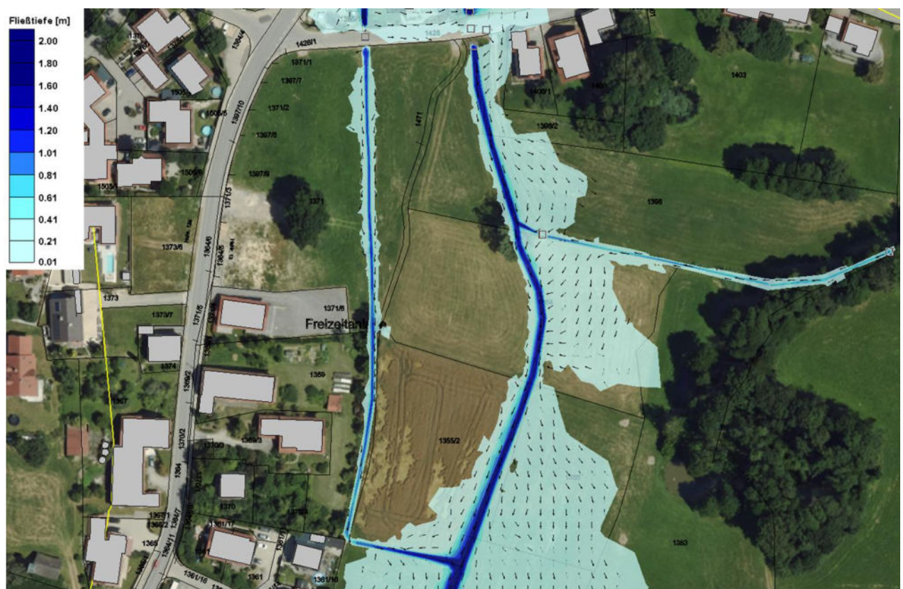
Abbildung 2.5: Abflusssituation im Ist-Zustand, HQ_{100} – Detailansicht Bauvorhaben
