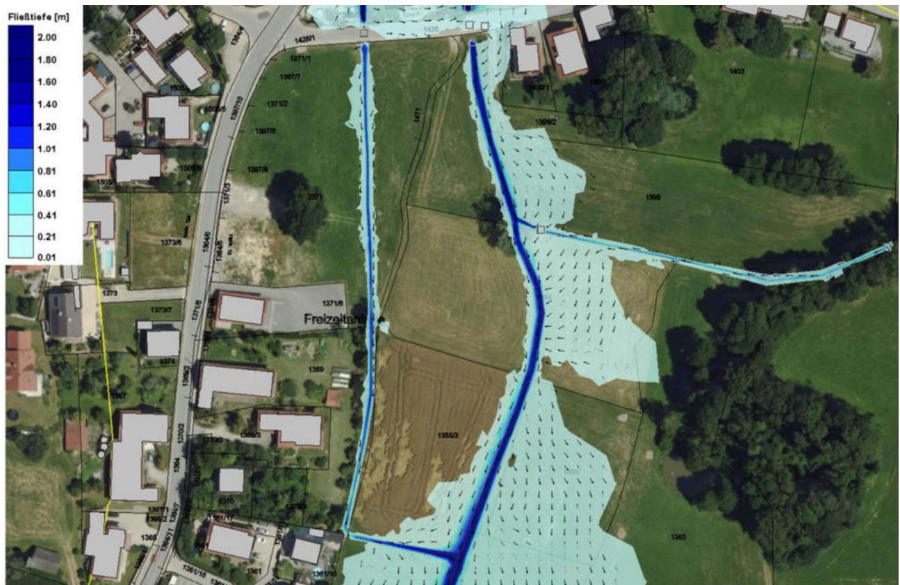
Abbildung 3.3: Abflusssituation im Ist-Zustand, HQ 100 – Detailansicht Bauvorhaben
