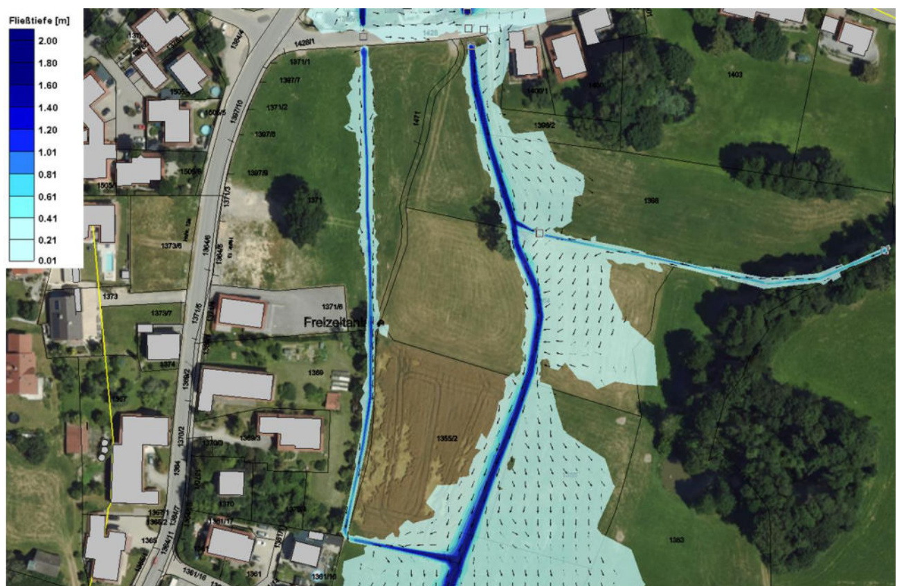
Abbildung 5.7: Abflusssituation im Ist-Zustand, HQ_{100} – Detailansicht Bauvorhaben
