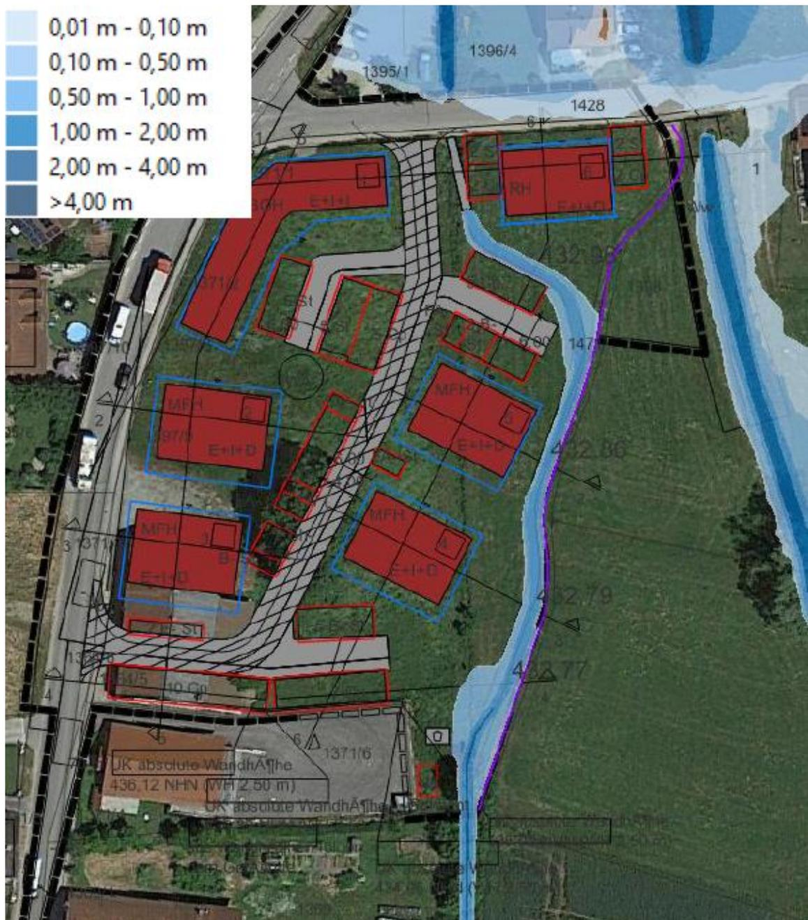
**Abb. 9:** Abflusssituation im Planungszustand, maximale Fließtiefen HQ100 – Detailansicht Bauvorhaben
