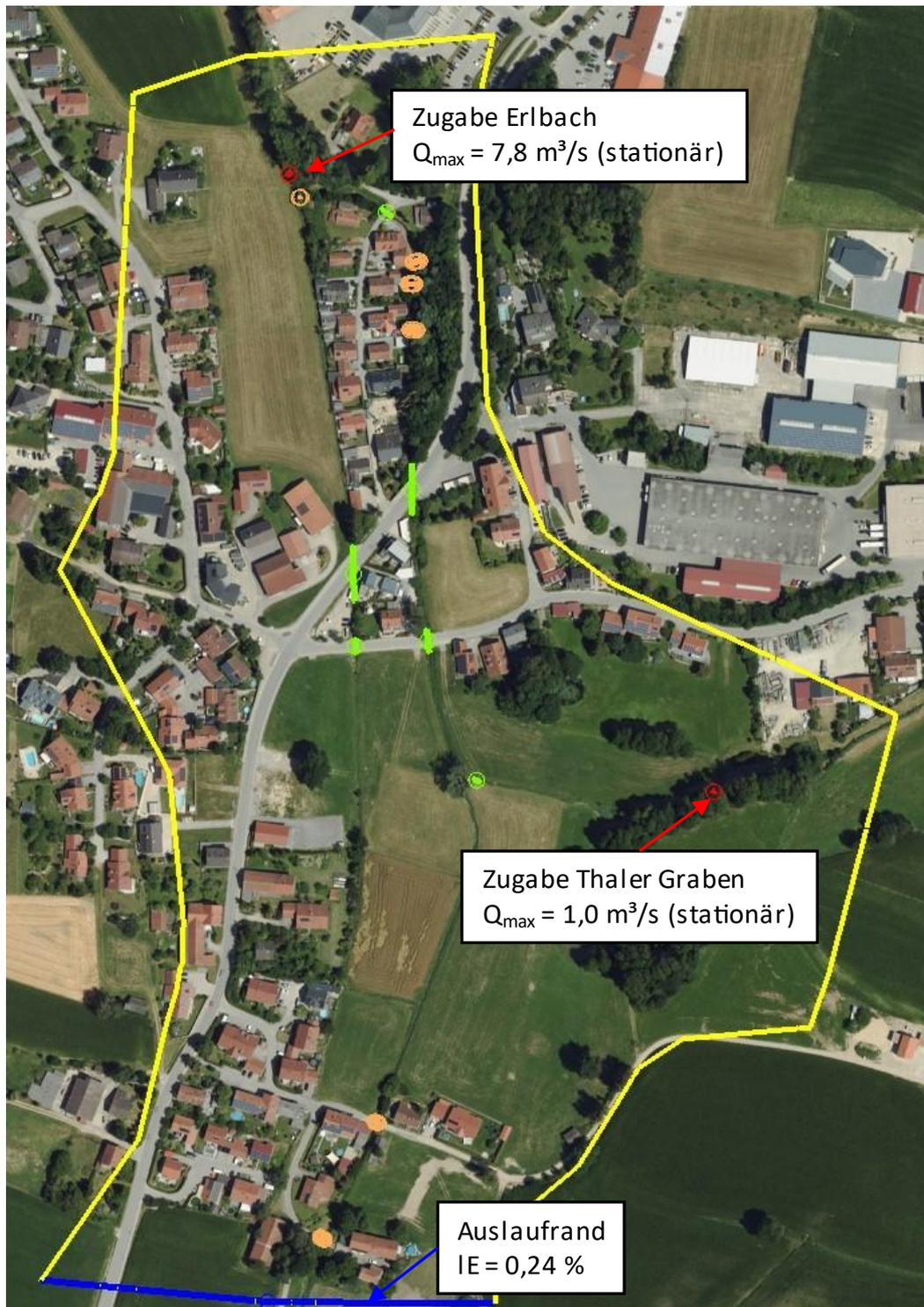
Abbildung 1.5: Zugaberandbedingungen (rot), Auslauftrandbedingungen (blau), Brücken und Wehre (orange) und Durchlässe (grün) des Abflussmodells;  $HQ_{100}$
