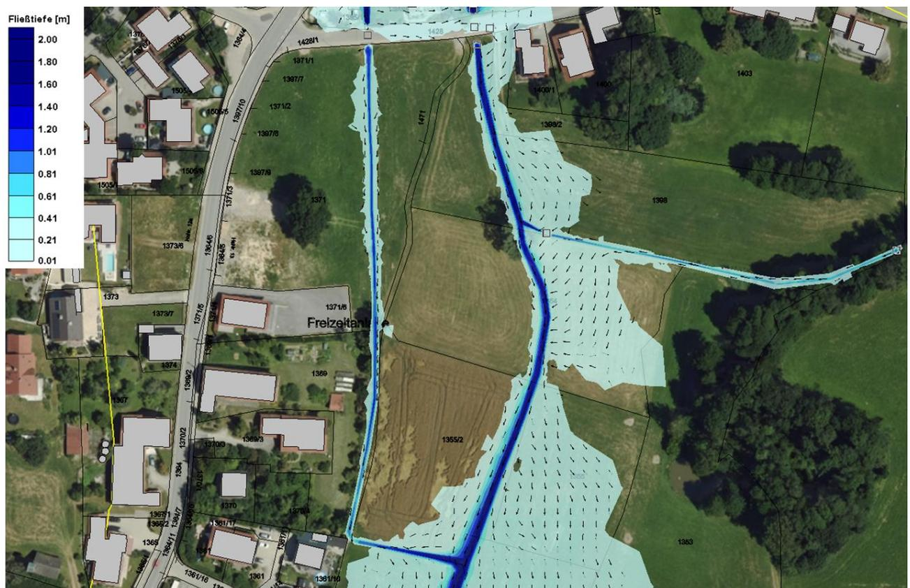
Abbildung 2.5: Abflusssituation im Ist-Zustand,  $HQ_{100}$  – Detailansicht Bauvorhaben
