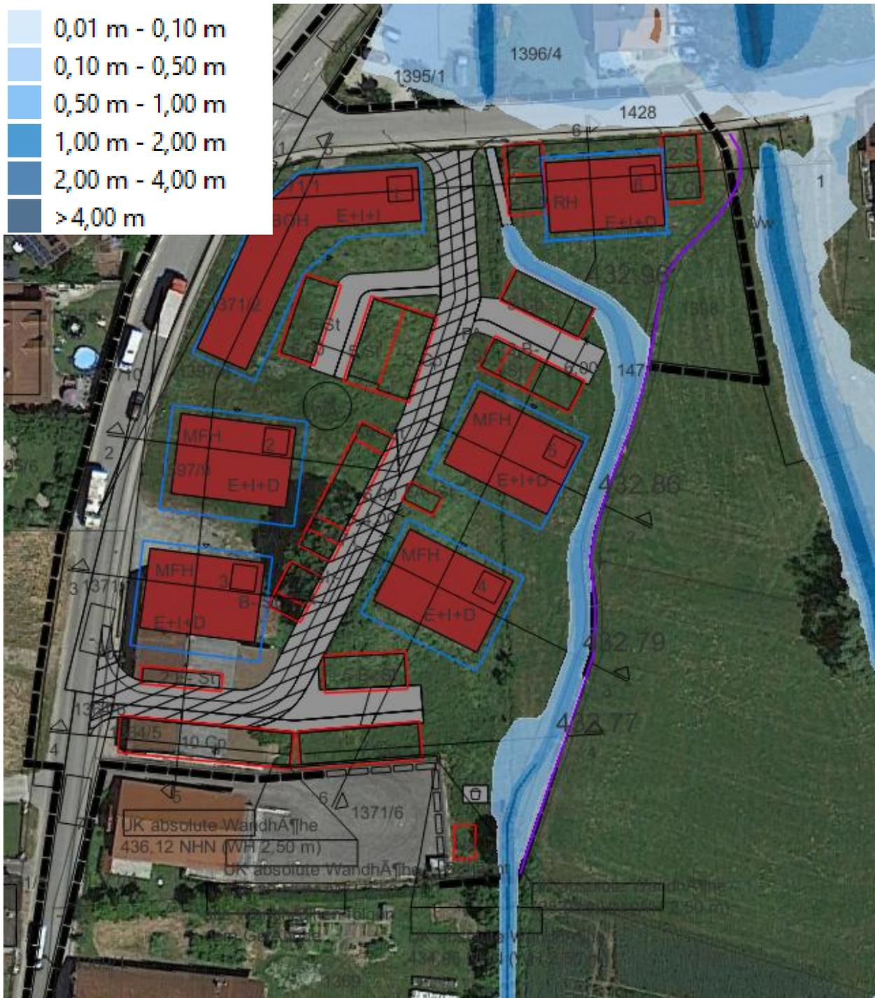
Abbildung 3.5: Abflusssituation im Planungszustand, Maximale Fließtiefen  $HQ_{100}$  – Detailansicht Bauvorhaben
